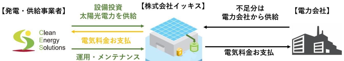
※PPA : Power Purchase Agreement (電力販売契約) の略称であり、施設所有者が提供する敷地や屋根などのスペースに太陽光発電設備の所有、管理を行う会社 (PPA 事業者) が設置した太陽光発電システムで発電された電力をその施設の電力使用者へ有償提供する仕組み。
