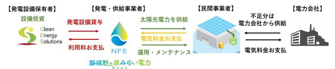
※PPA: Power Purchase Agreement(電力販売契約)の略称であり、施設所有者が提供する敷地や屋根などのスペースに太陽光発電設備の所有、管理を行う会社(PPA 事業者)が設置した太陽光発電システムで発電された電力をその施設の電力使用者へ有償提供する仕組み。
